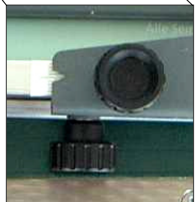
Detail 2 Feinverstellung für den Einlaufwinkel
